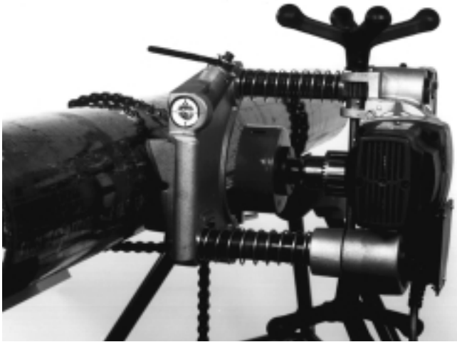
Figura 7 – La HC-450 haciendo un corte horizontal
